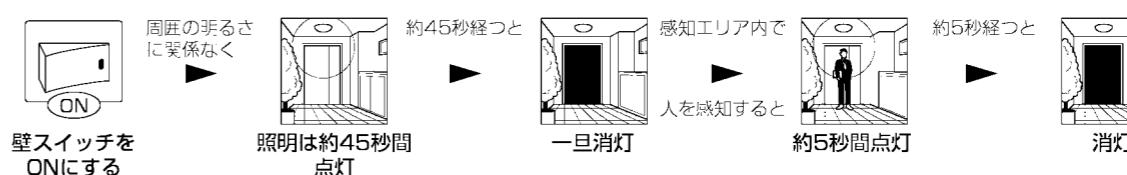
※感知エリアはセードの形状、気温、移動速度、進入方向、人の服装などにより変化しますので、あくまで目安としてください。
