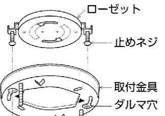
取付金具の矢印(◀▶)を止めねじに合わせて締め付ける。
