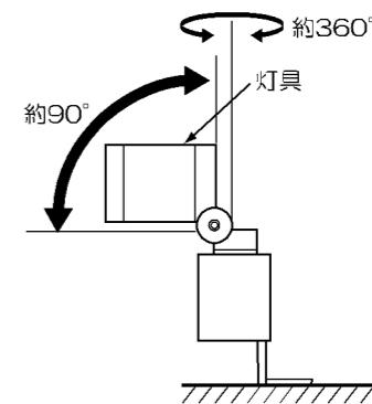
※器具固定ネジがゆるみ、器具が固定できなくなった場合は、六角レンチ(別途)で器具固定ネジを締め付けてください。
