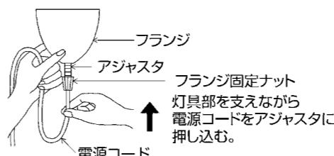
※電源コードの調整が固い場合は、一旦、フランジ固定ナットをアジャスターから取外し、もう一度2回転程締め付け、仮止めしてください。
