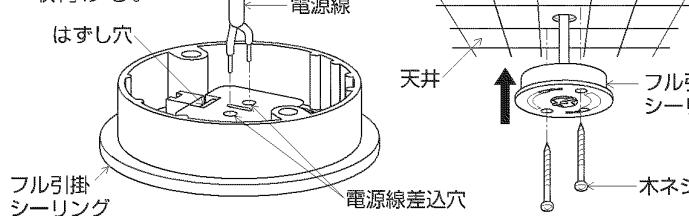
\*目透かし天井に取付ける場合は、目印を目透かし方向に合わせて木ネジで取付ける。
