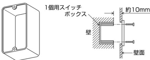
金属製スイッチボックス1個用(標準型またはカバー付) : JIS C 8340
