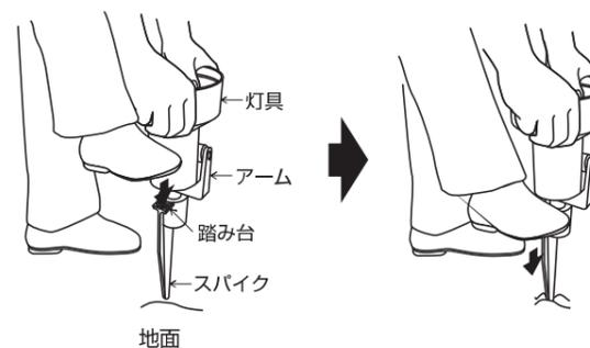
△ 注意 垂直以外の施工は行わないでください。埋込深さは指定の位置までの寸法を確保してください。転倒による感電・けが・破損の原因になります。
