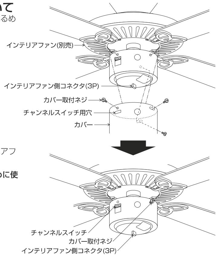
取外したカバー取付ネジのうち2本をインテリアファンに仮止めする。
