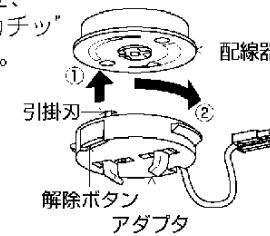
△警告 解除ボタンを押さずに左に回し、はすれないうことを確認してください。アダプタの取付けが不完全な場合、落下によるけがの原因になります。
