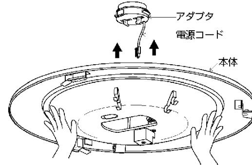
※本体の取付けは<埋込ローゼットの場合>、<その他の配線器具の場合>をご覧ください。<その他の配線器具の場合>で2段階押し上がりにくい場合は、本体の中央付近を押して、確実に取付けてください。
