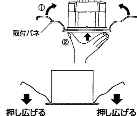
\*天井材厚が薄い場合、天井との間にすきまが空くことがありますので、この場合は一度バネを押し広げてから埋込穴に挿入してください。
