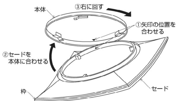
⚠警告 セードが確実に取付いたことを確認してください。取付けが不完全な場合、落下によるけがの原因になります。
