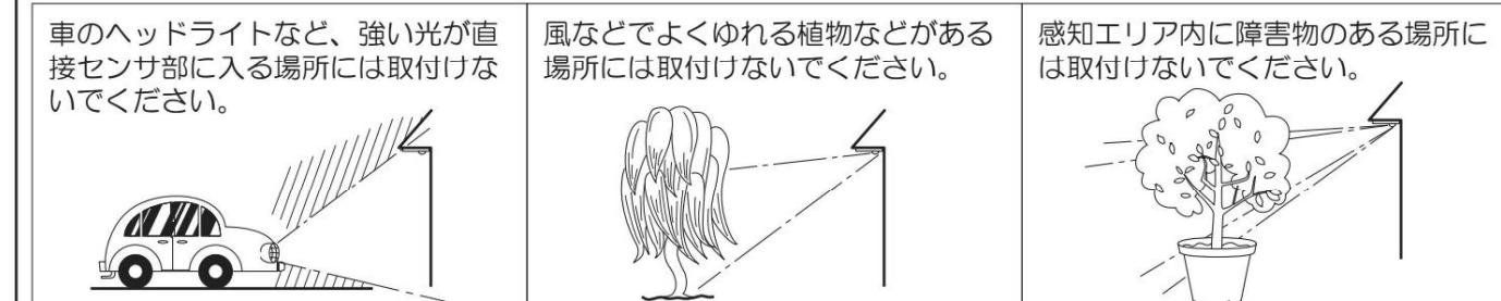
車のヘッドライトなど、強い光が直接センサ部に入る場所には取付けないでください。
