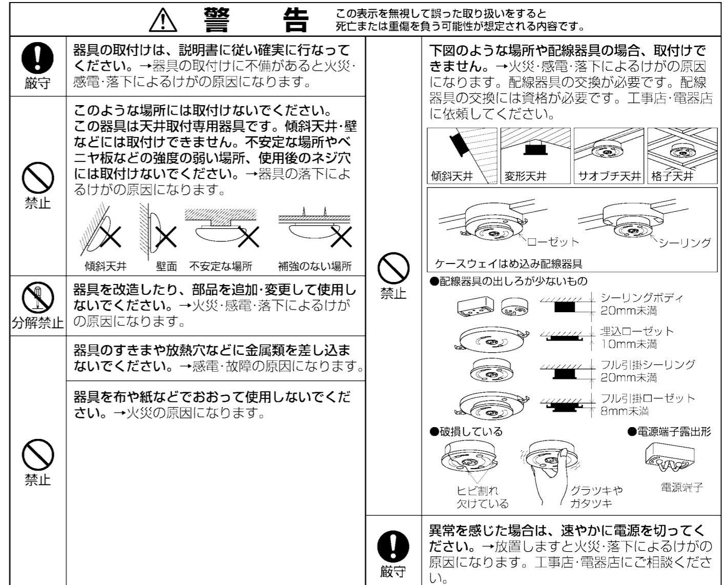
■取付手順 △注意 取付けの際は必ず電源を切ってください。感電の原因になります。
