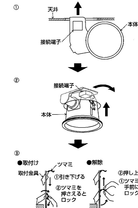
\*照射方向を確認の上、下図のように取付けてください。
