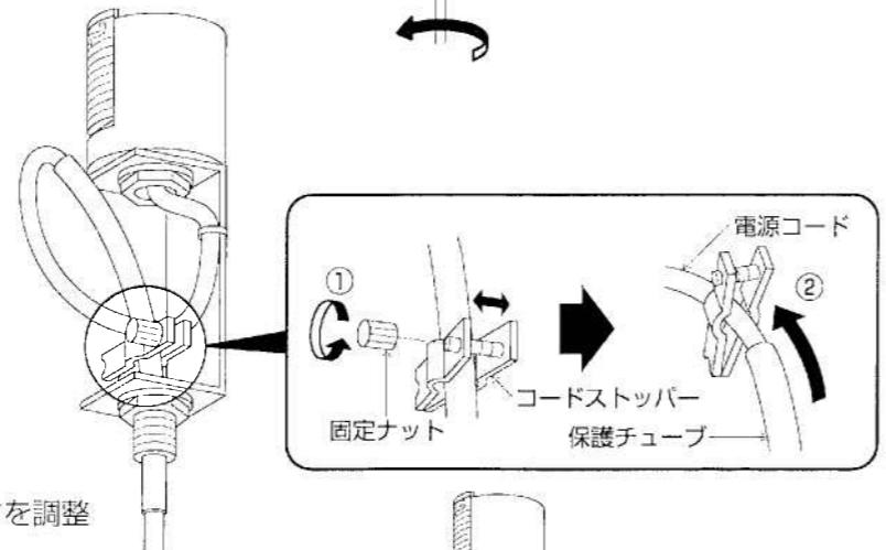
③保護チューブを持って、電源コードの長さを調整する。
