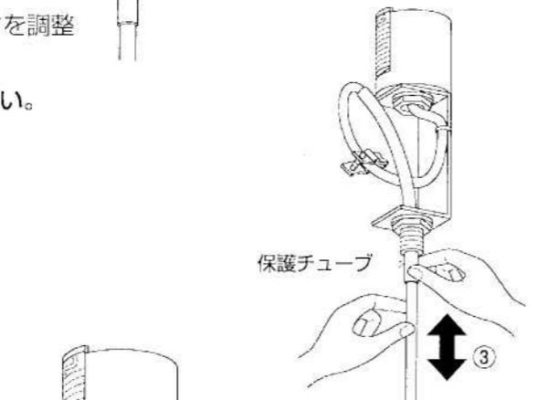
④コードストッパーを必ず元の位置まで戻し、固定ナットで確実に締め付ける。
