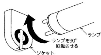
△ ランプの取付けは丁寧に、確実に行ってください。破損・落下の原因になります。
