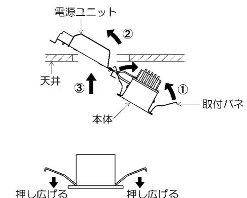
※天井材厚が薄い場合、天井との間に隙間が空くことがありますので、この場合は一度バネを押し広げてから埋込穴に挿入してください。
