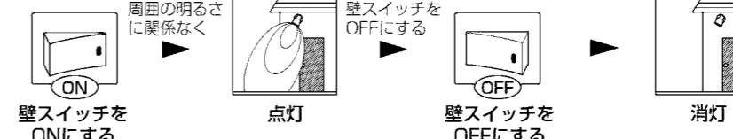
※電源投入後、約50秒間点灯し、その後センサ待機モードになります。人を感知するごとに点灯時間が延長しますが、電源投入から約60秒後に一旦消灯し、センサ待機モードになります。(連続点灯モードを除く。)
