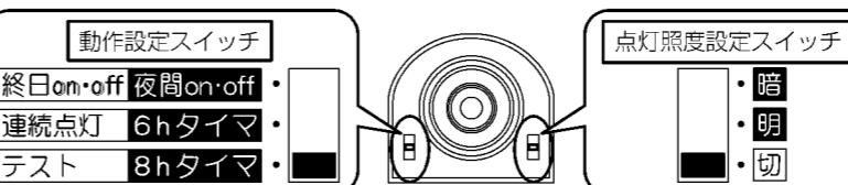
①電源投入後、約50秒間点灯し、その後テストモードになります。
