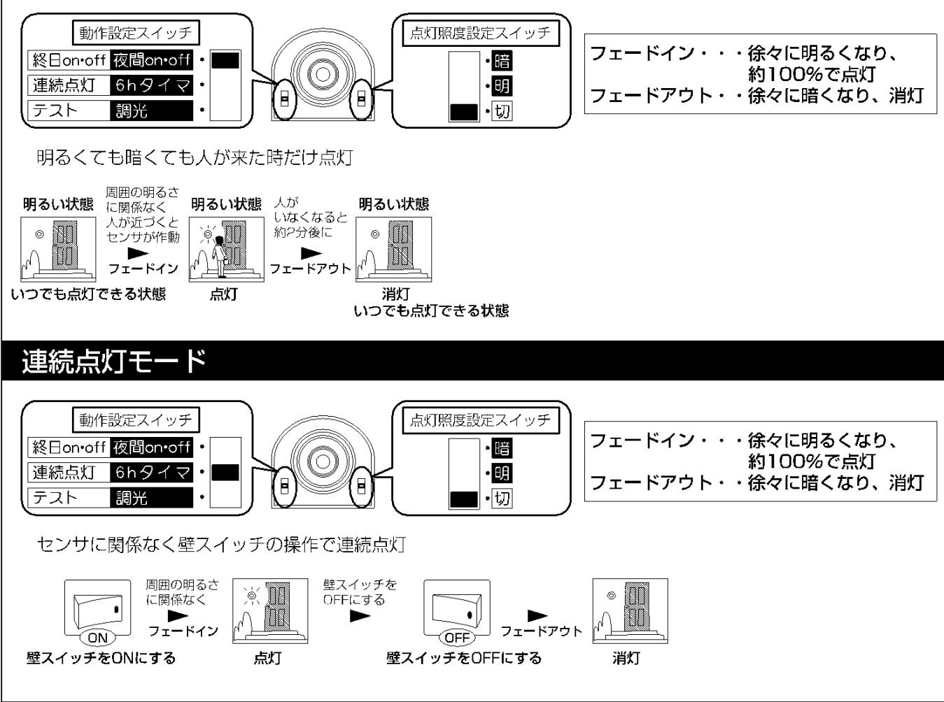
※電源投入後、約20秒間点灯し、その後約40秒間に明るくても人を感知するごとに約5秒間点灯します。
