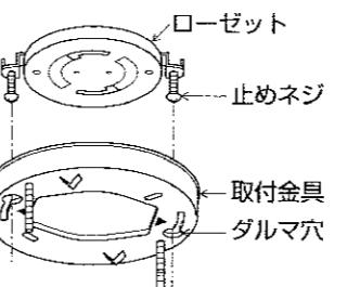
取付金具の矢印(◀▶)を止めねじに合わせて締め付ける。
