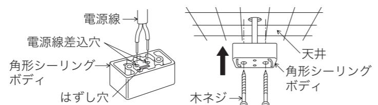
■取付け手順 △注意 取付けの際は必ず電源を切ってください。感電の原因になります。
