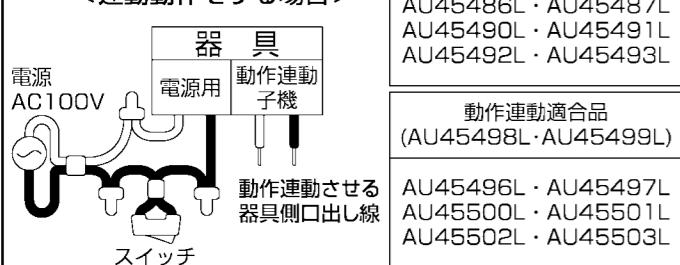
\*動作運動子機用の口出し線には絶対に電源線を接続しないでください。
