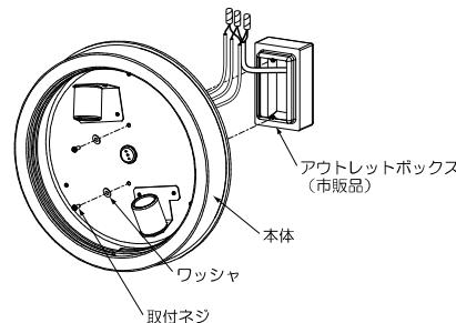
金属製アウトレットボックスは水が入った場合に備え、必ず排水管を設ける。
