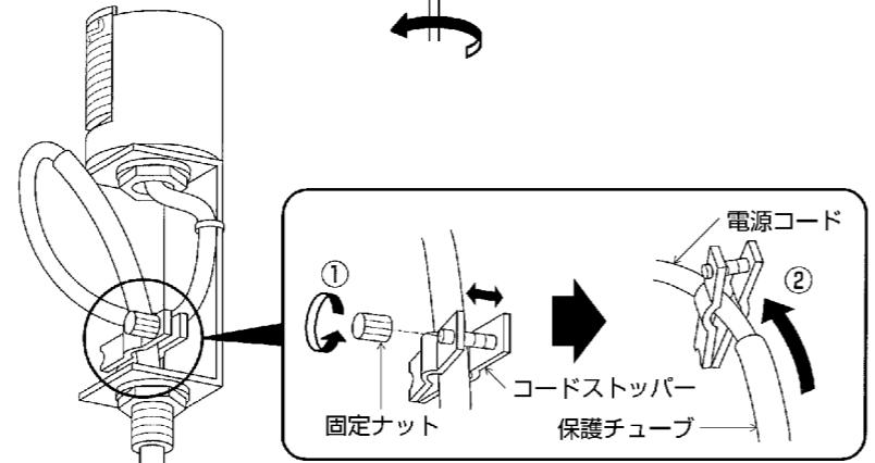
③保護チューブを持って、電源コードの長さを調整する。
