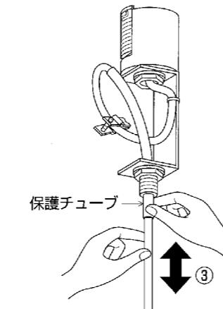
④コードストッパーを必ず元の位置に戻し、固定ナットで確実に締め付ける。
