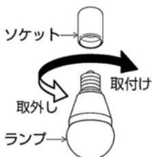
■グローブの取外し方 △注意 グローブの取外しの際は安全のため電源を切ってください。感電の原因になります。
