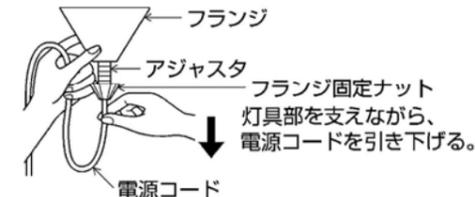
※電源コードの調整が固い場合は、一旦、フランジ固定ナットをアジャスタから取外し、もう一度2回転程締め付け、仮止めしてください。
