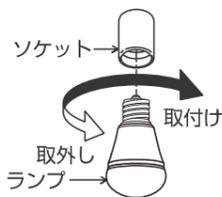
**■グローブの取外し方** △注意 グローブの取外しの際は安全のため電源を切ってください。感電の原因になります。
