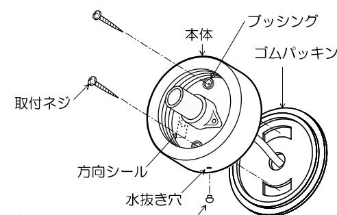
※ゴムパッキンの厚みの薄い部分と取付ネジの位置を合わせてから取付けてください。
