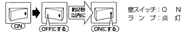
※連続点灯状態に切り替え後、約8時間で自動的に設定したセンサ待機モードに戻ります。また、連続点灯中に壁スイッチ操作(約2秒以内にOFF→ON)を行なった場合、再度その時点から約8時間の連続点灯モードになります。
