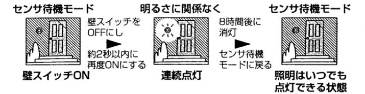
■モードの切り替えを壁スイッチで操作する (ブルレス操作)
