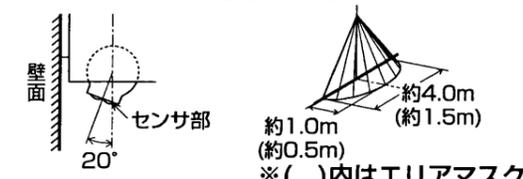
●センサを動かして感知エリアを調整できます。
