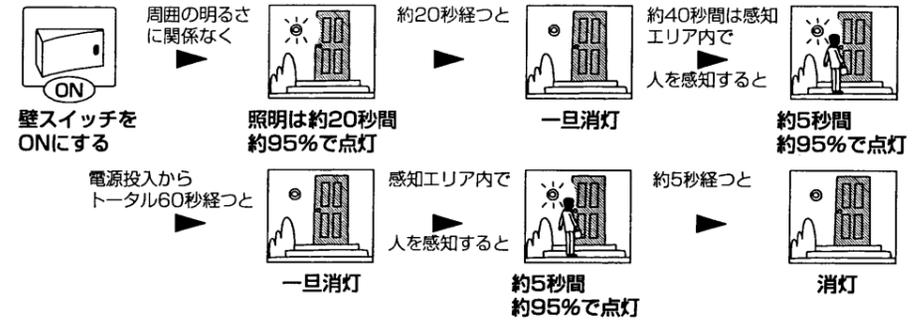
※感知エリアはセードの形状、気温、移動速度、進入方向、人の服装などにより変化しますので、あくまで目安としてください。
