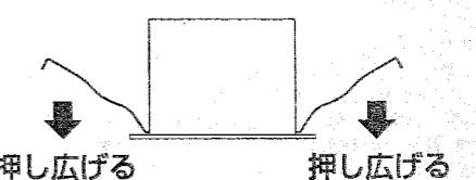
※天井材厚が薄い場合、天井との間にすきまが空くことがありますので、この場合は一度バネを押し広げてから埋込穴に挿入してください。
