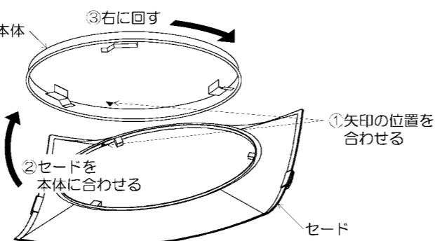
△警告 セードが確実に取付いたことを確認してください。取付けが不完全な場合、落下によるけがの原因になります。
