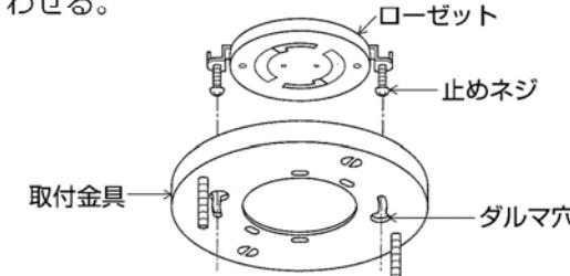
取付金具を回転させ、止めねじを締め付ける。
