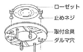
取付金具の矢印(▶◀)を止めねじに合わせて締め付ける。
