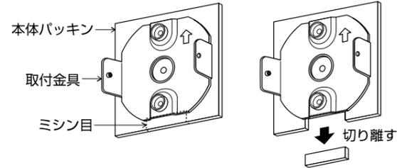
■施工手順 △注意 取付けの際は必ず電源を切ってください。感電の原因になります。
