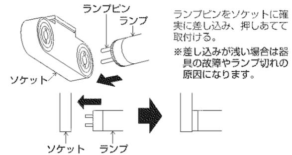
ランプピンをソケットに確実に差し込み、押しあてて取付ける。
