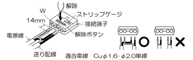
△警告 電源の接続は確実に行ってください。接続が不完全な場合や電源線が器具に接触した場合、容量オーバーした場合は火災・感電の原因になります。
