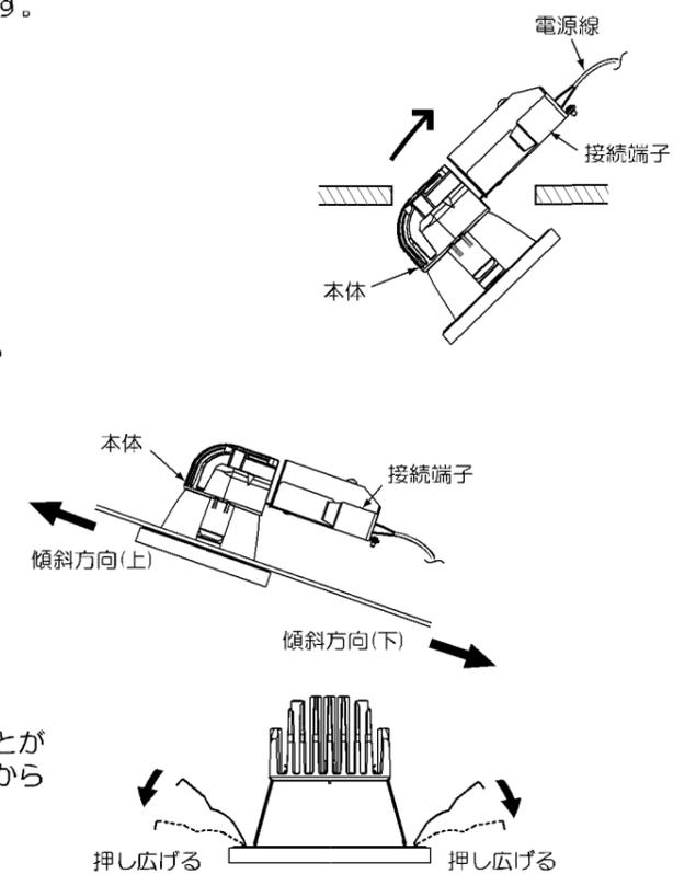
※天井材厚が薄い場合、天井との間に隙間が空くことがありますので、この場合は一度ハネを押し広げてから埋込穴に挿入してください。
