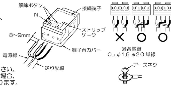
※動作連動子機用の接続端子には絶対に電源線を接続しないでください。
