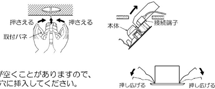
※天井材厚が薄い場合、天井との間に隙間が空くことがありますので、この場合は一度バネを押し広げてから埋込穴に挿入してください。
