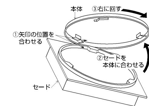
△警告 セードが確実に取付いたことを確認してください。取付けが不完全な場合、落下によるけがの原因になります。
