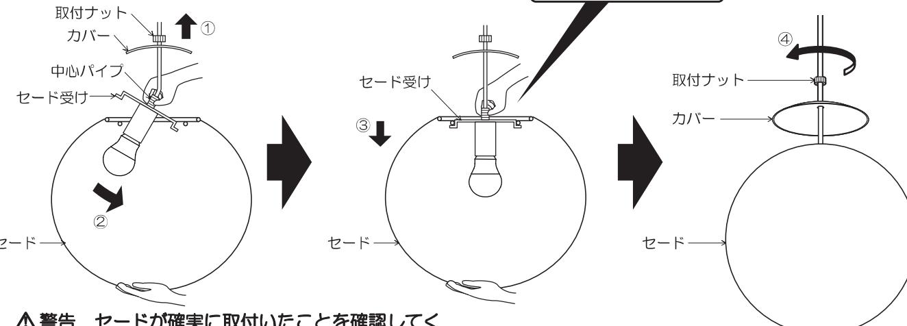
△警告 セードが確実に取付いたことを確認してください。取付けが不完全な場合、落下によるけがの原因になります。
