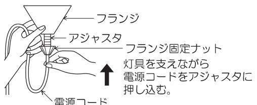
※電源コードの調整が固い場合は、一旦、フランジ固定ナットをアジャスターから取外し、もう一度2回転程締め付け、仮止めしてください。
