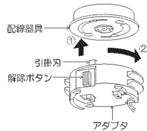
△警告 解除ボタンを押さずに左に回し、はずれないことを確認してください。アダプタの取付けが不完全な場合、落下によるけがの原因になります。
