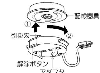
△警告 解除ボタンを押さずに左に回し、はずれないことを確認してください。アダプタの取付けが不完全な場合、落下によるけがの原因になります。
