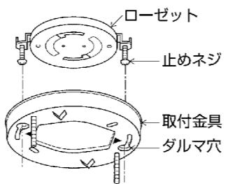
取付金具の矢印(◀▶)を止めねじに合わせて締め付ける。
