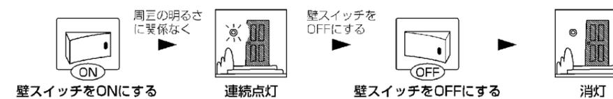
※電源投入後、約20秒間点灯し、その後約40秒間は明るくても人を感知することに約5秒間点灯します。電源投入から約60秒後に一旦消灯し、設定したモードになります。(連続点灯モードを除く。)
