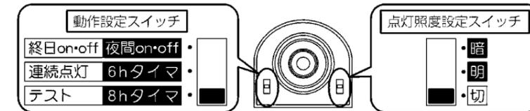
①電源投入後、約20秒間点灯し、その後は明るくても人を感知することにより約5秒間点灯します。結線および負荷の作動を確認できます。
