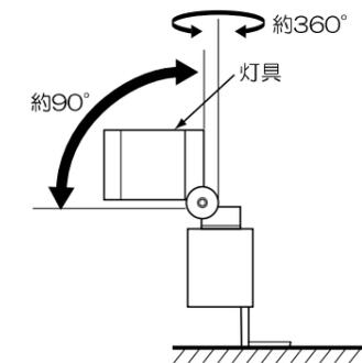
※灯具固定ネジがゆるみ、灯具が固定できなくなった場合は、六角レンチ(別途)で灯具固定ネジを締め付けてください。
