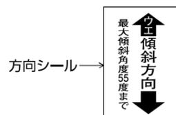
△警告 方向シールに従って取付けてください。指定方向以外に取付けた場合は火災・感電の原因になります。
