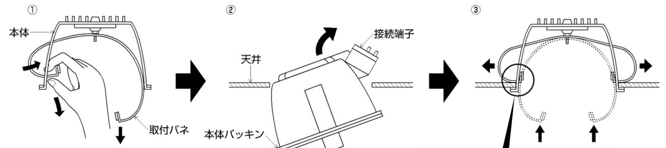
※反射板が外れにくい場合、反射板を矢印の方向へ押ししてください。
