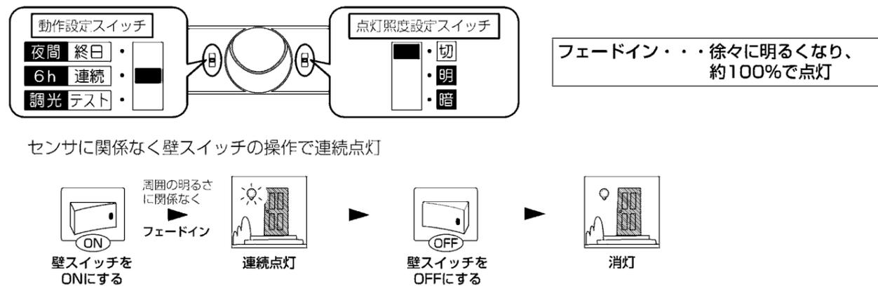
※電源投入後、約20秒間点灯し、その後約40秒間は明るくても人を感知することにより約5秒間点灯します。電源投入から約60秒後に一旦消灯し設定したモードになります。(連続点灯モードを除く。)
