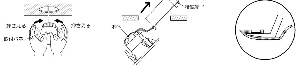
※天井材厚が薄い場合、天井との間に隙間が空くことがありますので、この場合は一度バネを押し広げてから埋込穴に挿入してください。
