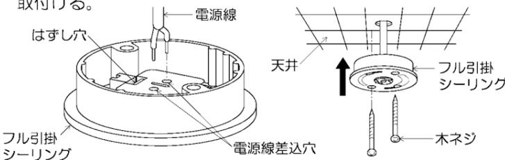
※目透かし天井に取付ける場合は、目印を目透かし方向に合わせて取付ける。
