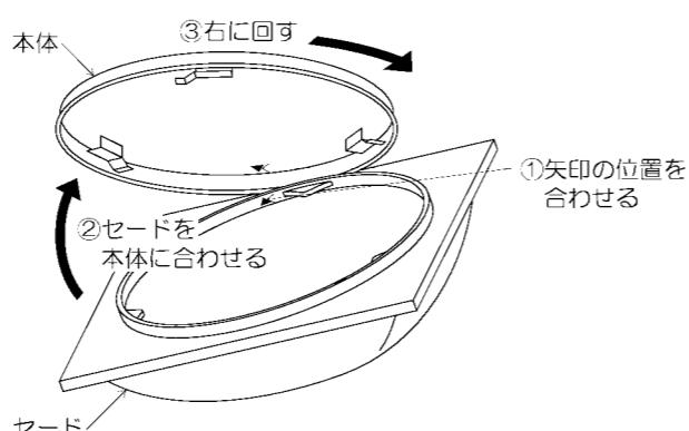
△警告 セードが確実に取付いたことを確認してください。取付けが不完全な場合、落下によるけがの原因になります。
